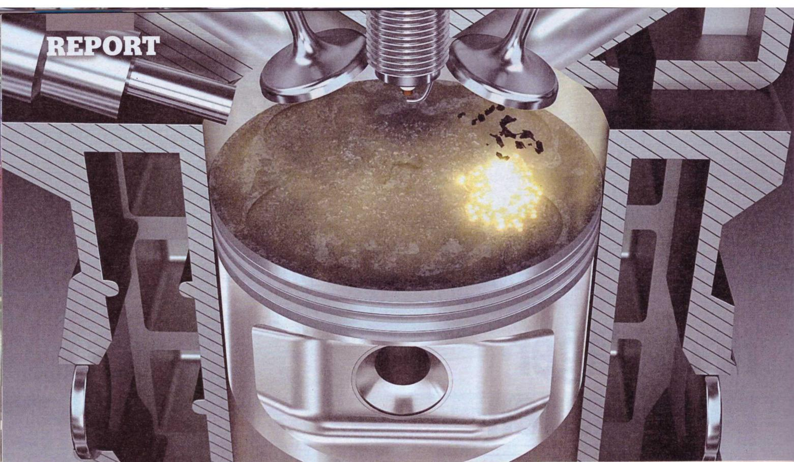
▲ Zu früher Funke: Die Grafik zeigt das Problem. Glühende Rückstände sorgen für die fehlerhafte Verbrennung
